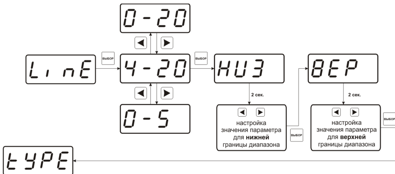
Рисунок 6.16 Схема настройки токового выхода.
